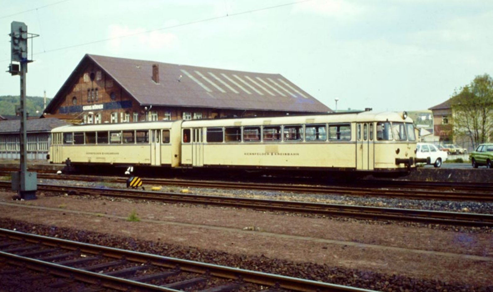
Die Hersfelder Kreisbahn beschaffte in den 1960er Jahren neue Fahrzeuge, darunter VT 54. Dieser Gliederzug bestand aus einem fest verbundenen Motor- und Steuerwagen. 20.05.1980
